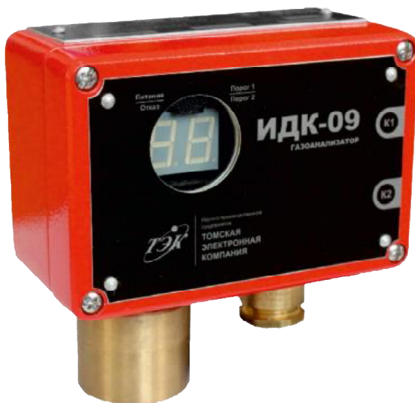
Рисунок 1 – Газоанализатор ИДК-09, климатическое исполнение У1
